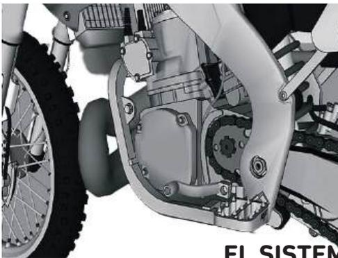
En un motor de dos tiempos el aceite se mezcla con el combustible. Las motocicletas modernas tienen un estanque separado para el aceite, que debe llenarse con un aceite especial para motores de dos tiempos. Las motocicletas antiguas carecen del estanque separado, debiendo su conductor mezclar el aceite con la gasolina siguiendo las recomendaciones del fabricante. Actúe con especial rigurosidad al realizar esta mezcla.
